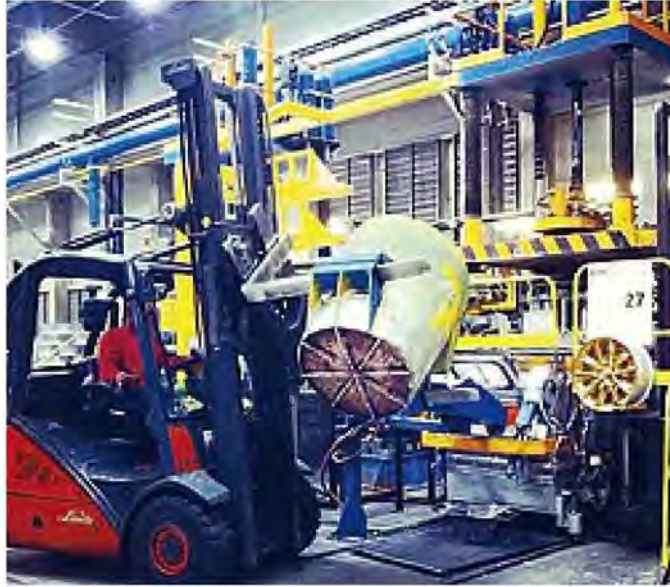
Macchinari Uno dei 32 nuovi impianti di colata per i cerchi in lega di alluminio
